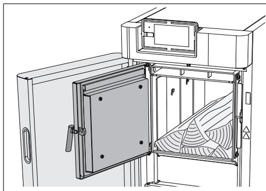
Fermer la porte de remplissage et la porte isolante
