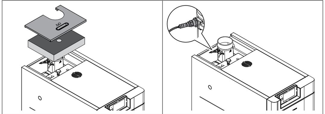
☐ Déposer par le haut le couvercle isolant arrière et l'isolation thermique
