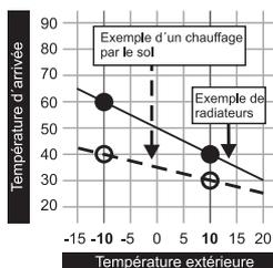
La courbe de chauffe du circuit de chauffage permet de calculer une température de départ, en fonction de la température extérieure et avec les deux paramètres réglables « température de départ avec température extérieure de  $-10\text{ °C}$  » et « température de départ avec température extérieure de  $+10\text{ °C}$  ».
