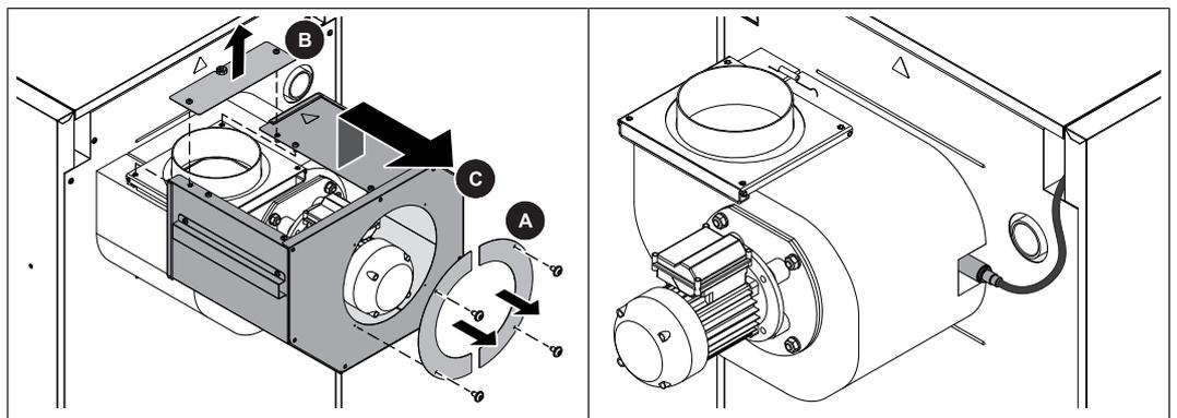
☐ Démontez les caches de tirage (A), le recouvrement arrière (B) et le carter (C)
