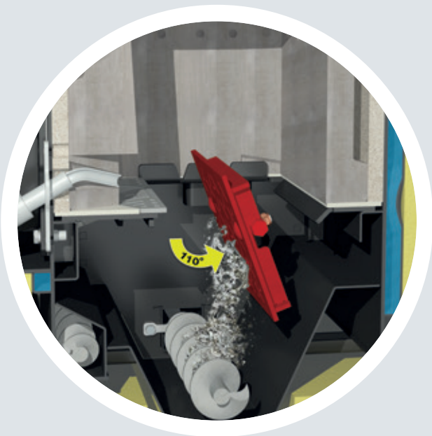
Grazie all'inclinazione di 110°, la cenere viene svuotata completamente dalla griglia inclinabile e scaricata nel contenitore cenere mobile di grande volume con l'ausilio della coclea cenere.
