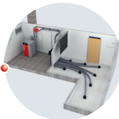
Système d'aspiration des granulés RS4 / RS8 Automatique avec lavage à contre-courant
