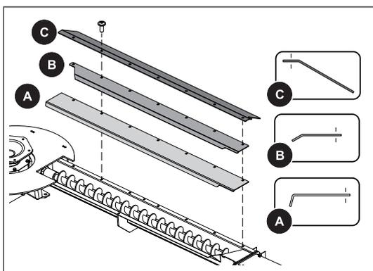
Monte las placas de cubierta en el canal abierto con los tornillos alomados M10×25.
