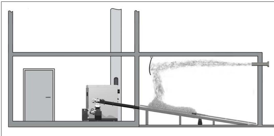
Si el cabezal del agitador ya está libre de material y los brazos del agitador/las ballestas están desplegados, estos deben cubrirse y plegarse en el silo junto con el combustible que queda. Realice estos trabajos a tiempo antes de la fecha acordada de llenado.
