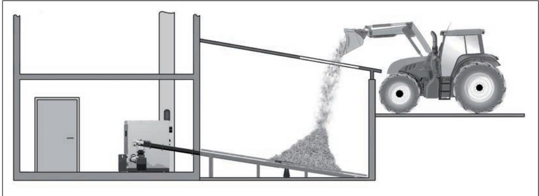
Si el cabezal del agitador ya está libre de material y los brazos del agitador/las ballestas están desplegados, el dispositivo de transporte debe permanecer activado hasta el pliegue completo de los brazos del agitador/las ballestas.
