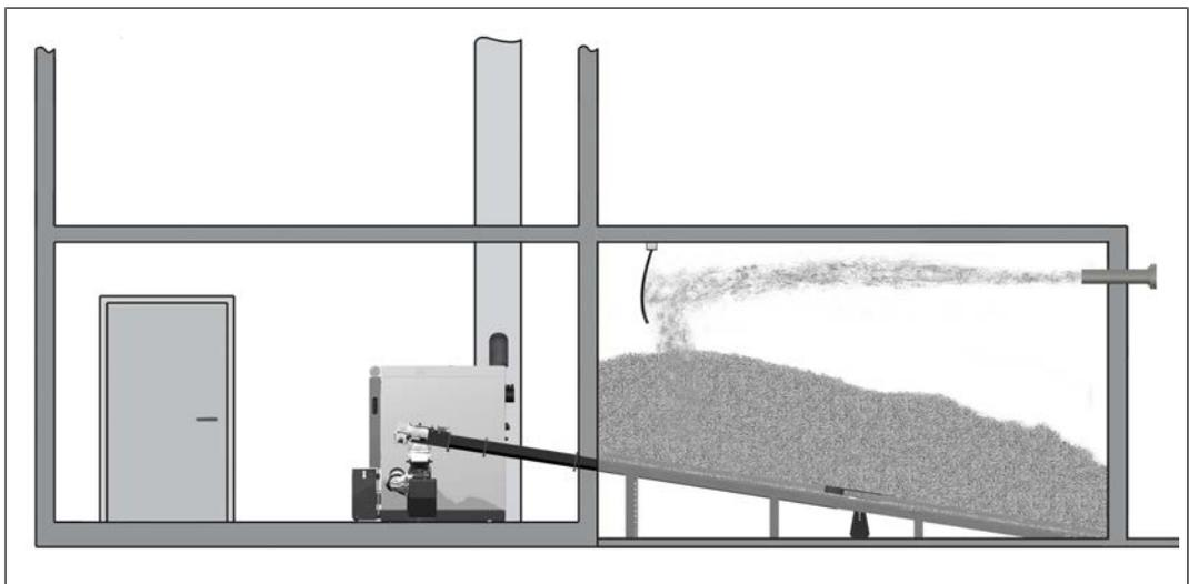
Si todavía hay suficiente combustible en el silo (el cabezal del agitador está completamente cubierto de combustible y los brazos del agitador/las ballestas no están extendidos), el silo se puede llenar de la siguiente manera:
