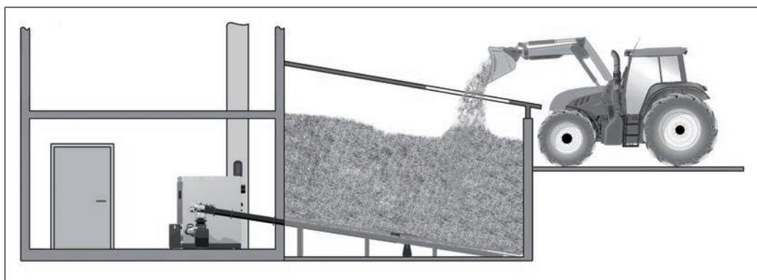
Si todavía hay suficiente combustible en el silo (el cabezal del agitador está completamente cubierto de combustible y los brazos del agitador/las ballestas no están extendidos), se puede llenar el silo:
