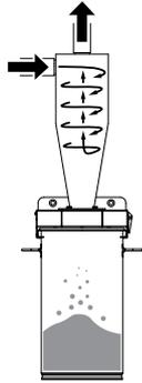
Fröling Pellets-Saugsysteme können mit einem Pelletsentstauber PST ausgestattet werden.
