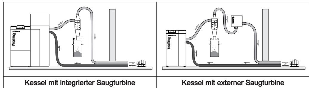
Der Staub-Abscheidezyklon wird in die **Rückluftleitung** des Pellets-Saugsystems eingebaut, wo die in der Rückluft enthaltenen Staubpartikel abgesondert werden. Die Position des Entstaubers in der Rückluftleitung kann dabei frei gewählt werden.
