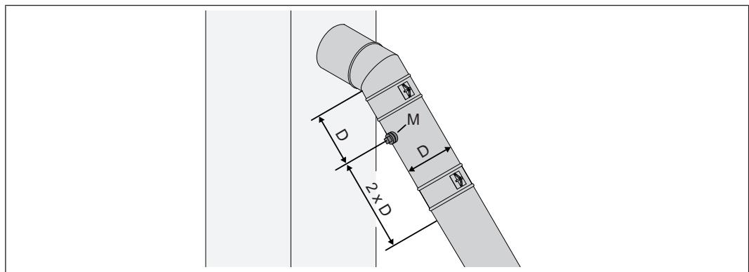
Ispred mjernog otvora (M) trebala bi se nalaziti ravna ulazna sekcija, u razmaku koji približno odgovara dvostrukom promjeru ( $D$ ) priključnog voda. Nakon otvora za mjerjenje, treba predvidjeti ravnu izlaznu sekciju, u razmaku, koji približno odgovara jednostrukom promjeru priključnog voda. Mjerni otvor uvijek mora biti zatvoren dok sustav radi.
