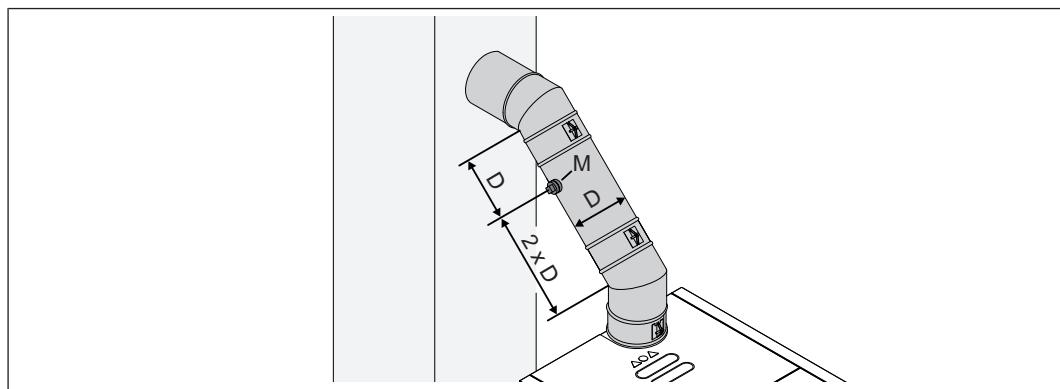
Pred merilno odprtino (M) mora biti raven dovodni odsek povezovalnega voda, dolg približno dva premera (D) povezovalnega voda. Za merilno odprtino mora biti raven odvodni odsek povezovalnega voda, dolg približno en premer povezovalnega voda. Merilno odprtino imejte med delovanjem sistema vedno zaprto.
