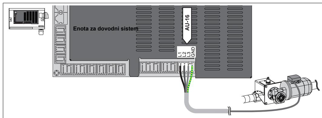
Gonilni motor sesalnega polža za pelete priključite na enoto za dovodni sistem v stenski omarici
