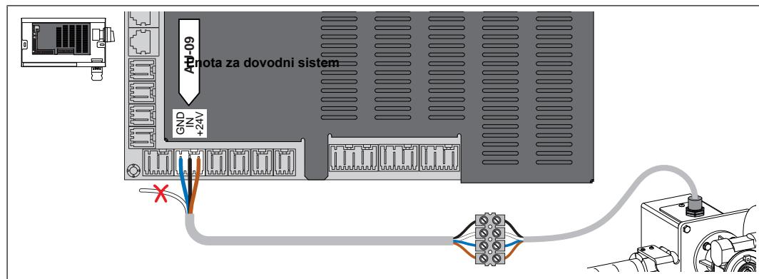
Tipalo sesalnega polža za pelete priključite na enoto za dovodni sistem v stenski omarici
