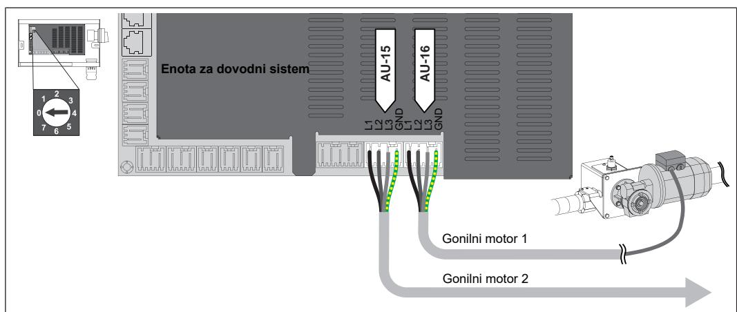
Gonilni motor sesalnega polža pelet 1 in 2 priključite na enoto za dovodni sistem (naslov 0) v stenski omarici
