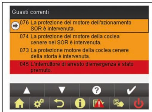
Il termine "guasto" è un termine generico che riunisce i concetti di avvertenza, errore o allarme. I tre tipi di messaggi si differenziano nel comportamento della caldaia:
