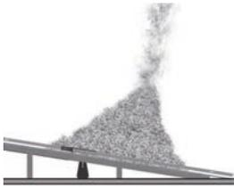
Se la testa dell'estrattore non è stata coperta a sufficienza distribuendo il combustibile residuo:
