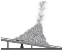
Si el cabezal del agitador no se ha cubierto lo suficiente con la distribución del combustible que queda:
