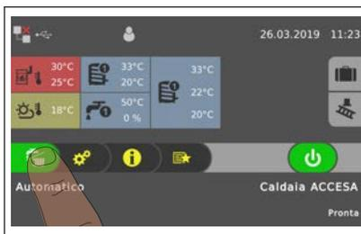
A seconda del tipo di caldaia sono possibili diversi modi operativi che possono essere modificati direttamente nel display base del touchscreen.
