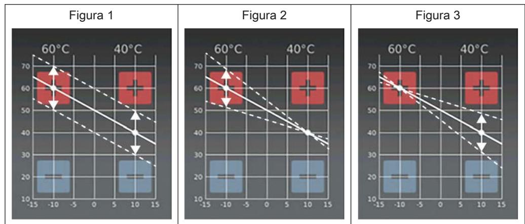
La curva di riscaldamento può essere modificata a seconda della situazione toccando i tasti "+" o "-" con una temperatura esterna di  $\pm 10^{\circ}\text{C}$ .
