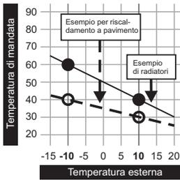
Tramite la curva di riscaldamento del circuito di riscaldamento, in base alla temperatura esterna, viene calcolata una temperatura di mandata con due parametri impostabili "Temperatura mandata con temperatura esterna -10°C" e "Temperatura mandata con temperatura esterna +10°C".
