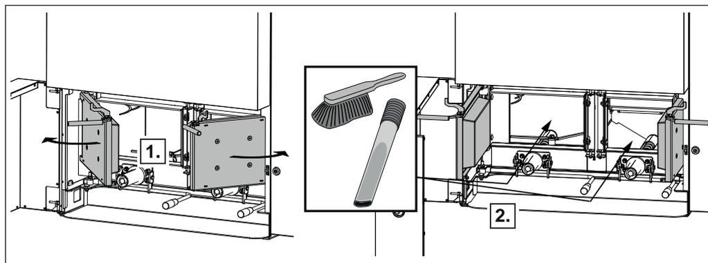
**NOTA! Pulire la griglia e la camera di combustione solo se la caldaia si è raffreddata!**
