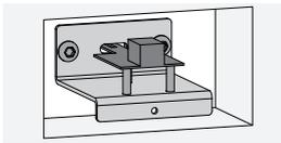
**NOTA! Montare il sensore di flusso come illustrato per evitare guasti di funzionamento!**
