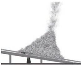
Wenn der Rührwerkskopf durch Verteilen des restlichen Brennstoffes nicht ausreichend bedeckt wurde:
