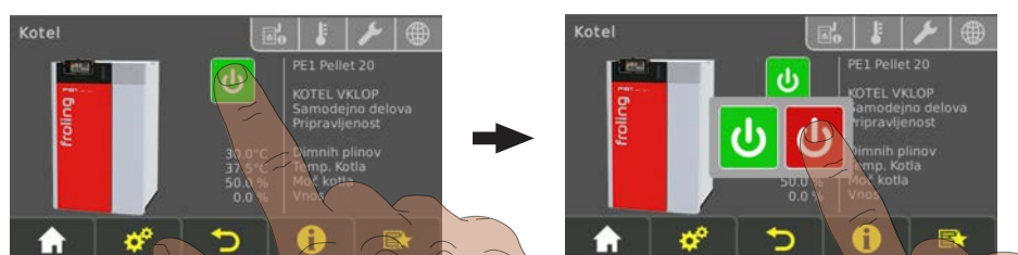
Daljinsko preklapljanje kotla izklopljeno
