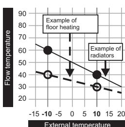
Korištenjem krivulje grijanja kruga grijanja izračunava se temperatura polaza, ovisno o vanjskoj temperaturi, s dva podesiva parametra „Vorlauftemperatur bei -10 °C Außentemperatur“ („Temperatura polaza kod -10 °C vanjske temperature“) i „Vorlauftemperatur bei +10 °C Außentemperatur“ („Temperatura polaza kod +10 °C vanjske temperature“).
