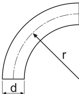
Odnos polumjera zakrivljenosti ( $r$ ) i promjera cijevi ( $d$ ) treba biti veći od 1
