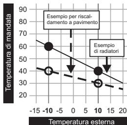
Tramite la curva di riscaldamento del circuito di riscaldamento, in base alla temperatura esterna, viene calcolata una temperatura di mandata con due parametri impostabili "Temperatura mandata con temperatura esterna  $-10^{\circ}\text{C}$ " e "Temperatura mandata con temperatura esterna  $+10^{\circ}\text{C}$ ".
