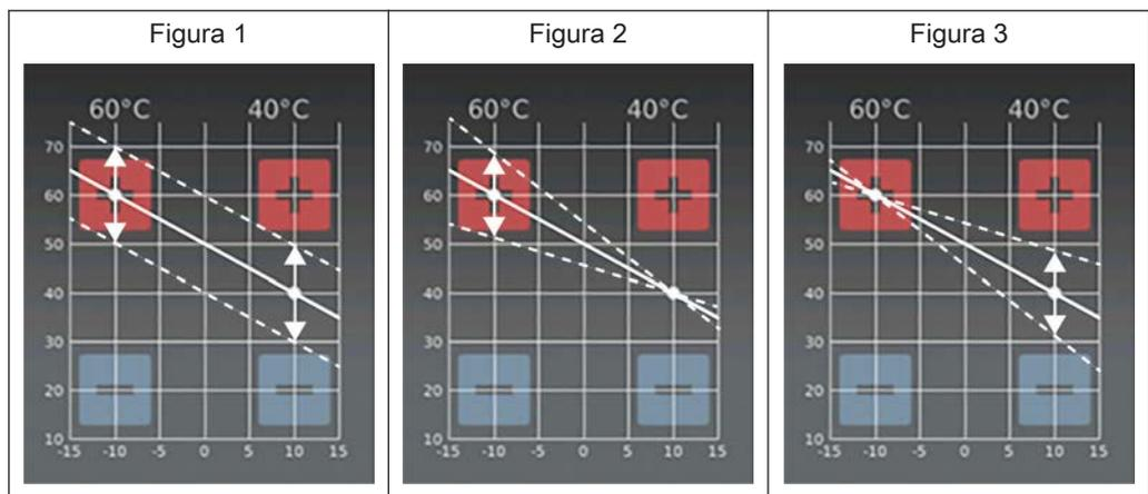
La curva di riscaldamento può essere modificata a seconda della situazione toccando i tasti "+" o "-" con una temperatura esterna di +/-10°C.
