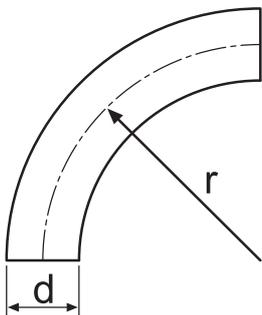
Il rapporto tra il raggio di curvatura (r) e il diametro del tubo (d) deve essere superiore a 1
