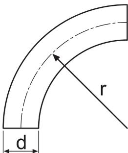
La relación entre el radio de curvatura (r) y el diámetro del tubo (d) debe ser mayor que 1.
