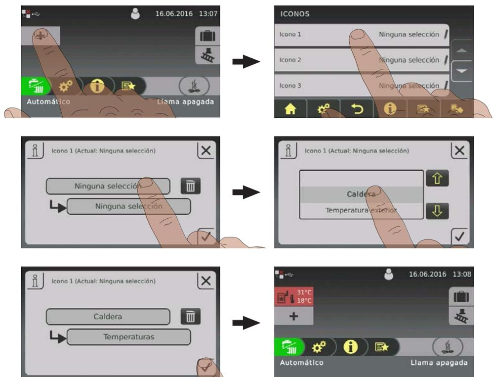
Si se utilizan más de dos sensores del acumulador, es posible mostrar una información con las temperaturas del acumulador según el número de sensores. La representación se realiza en una pantalla de información con dos áreas diferentes.
