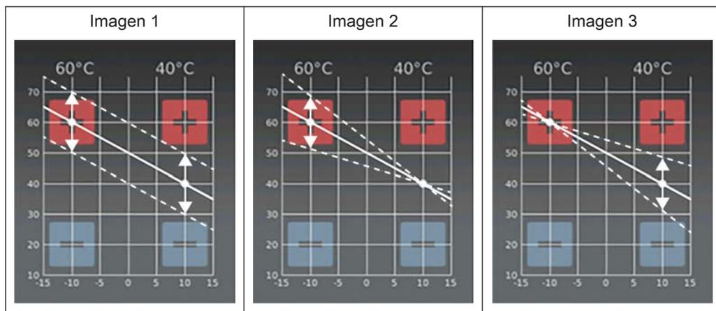
La curva de calentamiento puede adaptarse en función de la situación pulsando “+” o “-” a una temperatura exterior de ±10 °C.
