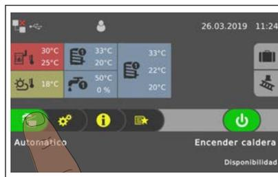
En función del tipo de caldera, existen varios modos operativos que pueden modificarse directamente en la pantalla básica de la pantalla táctil.
