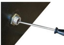
Una vez que la temperatura ha descendido por debajo de aprox. 75 °C, el termostato de seguridad se puede desbloquear mecánicamente.
