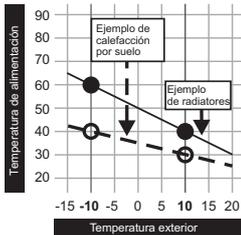
La curva de calentamiento del circuito de calefacción permite calcular una temperatura de alimentación en función de la temperatura exterior con los dos parámetros ajustables "Temperatura de alimentación a una temperatura exterior de +10 °C" y "Temperatura de alimentación a una temperatura exterior de -10 °C".
